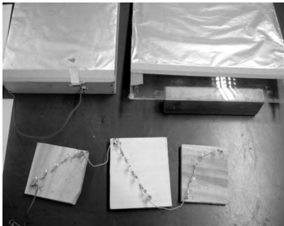
図2 発光ダイオードの直列接続と学生が作成した発電装置
