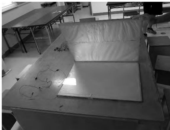
図4 大型の発電装置の固定電極と可動電極が平行になっている状態
