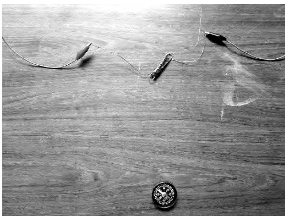
図11 電磁石の影響が少なく方位磁針が離れている状態
