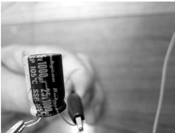
図9 太陽電池に接続されたコンデンサー（充電状態）
