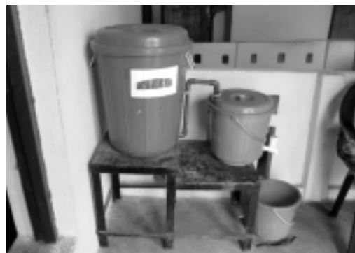
写真 5.2 現地で使用されているヒ素除去フィルター
