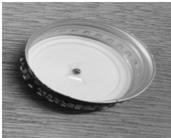
図4 フタにガラスビーズを取り付け、セロハンテープで固定した様子
