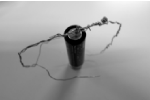
図10 モーターが回っている様子(太い〔0.5mm程度〕真鍮線使用)
