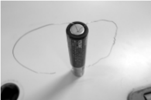
図9 モーターが回っている様子(細い真鍮線使用)
