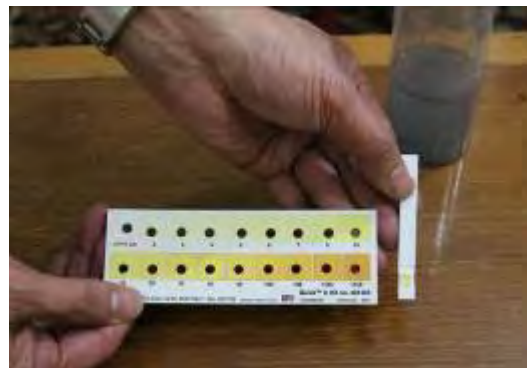
写真 4.3.10 地下水中のヒ素分析状況
