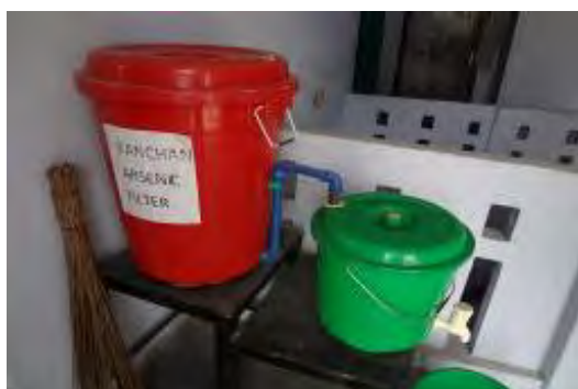
写真 6.3.1 ヒ素除去フィルター
