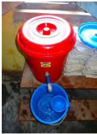
写真 6.4.5 ピパラのバルプリ小学校で使われているヒ素除去フィルタープラスチック製のバケツを利用したようなもので，鉄釘（上層）と砂（下層）が入っている．教職員は使っているが，生徒達にはフィルターの利用がされていない．生徒のためのヒ素除去フィルター等の安全な水の確保が必要。
