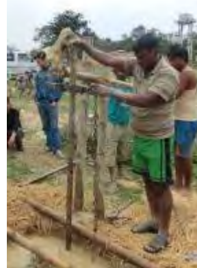
写真 4.3.4 堆積物採取のための掘削調査
