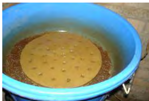
図 6.3.2 ヒ素除去フィルター内の鉄釘
