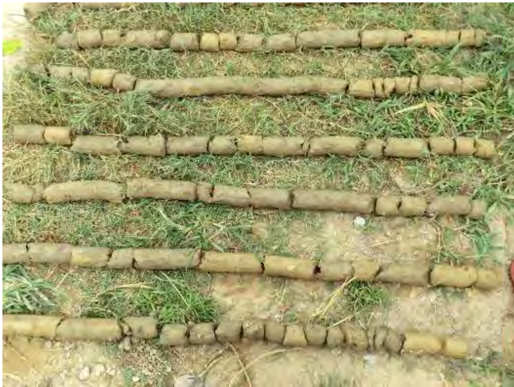
井戸掘ボーリングサンプル 2012年8月
