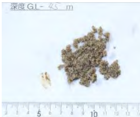
写真 4.3.7 第3帯水層を構成する砂層 (細粒砂～中粒砂)
